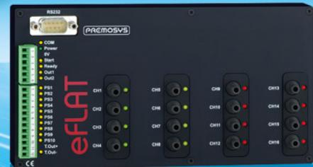
Mit dem System können durch 4 Produktvarianten von 4 bis zu 16 LEDs parallel getestet werden. Farbe und Intensität können unabhängig voneinander für jeden Messkanal parametriert werden. eFLAT lässt sich durch Kalibrierfunktionen auf hohe absolute Genauigkeiten trimmen. Ebenso kann der Kunde Kalibrierungen mit eigenem Messequipment durchführen und somit die absolute Genauigkeit weiter steigern.
